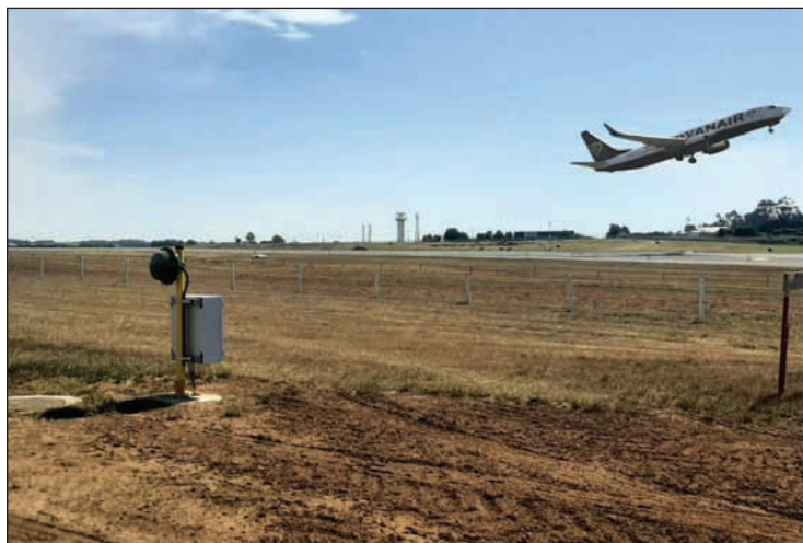
Il sistema rileva: attraversamento aerei in corrispondenza delle fermate, ingresso pista nella direzione sbagliata, transito di più aerei sulla stessa pista, attraversamento Stop Bar
