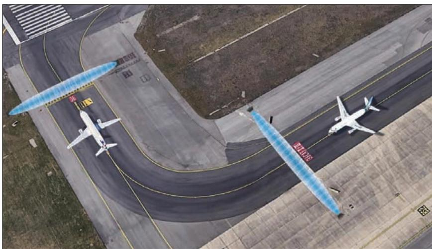
Per prevenire collisioni tra aerei nel movimento a terra, i principali aeroporti del Portogallo utilizzano le barriere ERMO 482X3PRO-AIR di CIAS ai bordi delle vie di rullaggio
