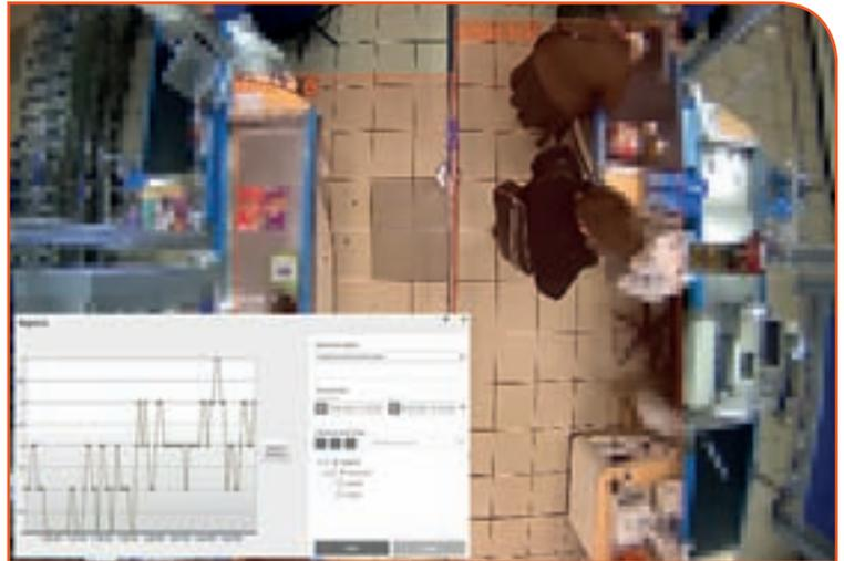
■ Macroscop fornisce il Tracking dei Comportamenti Sospetti per la post-analisi del comportamento: ricostruisce i movimenti di un individuo in ordine cronologico anche da centinaia di video provenienti da diversi punti di ripresa
