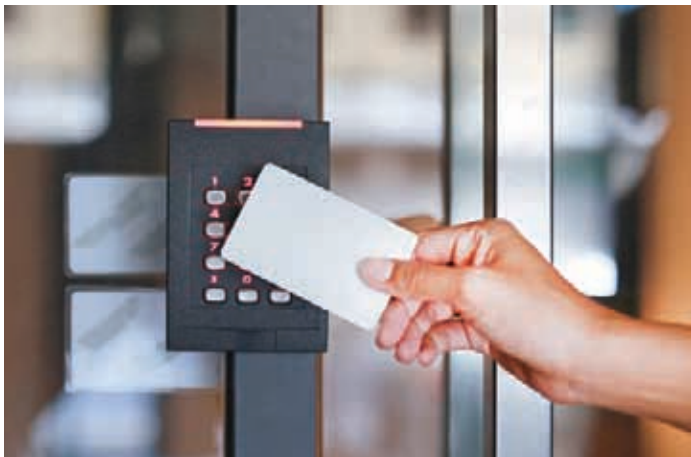
Le componenti specifiche di un sistema elettronico di controllo accessi basato su tecnologia RfId sono la credenziale (badge o transponder) e il lettore installato in prossimità del varco
