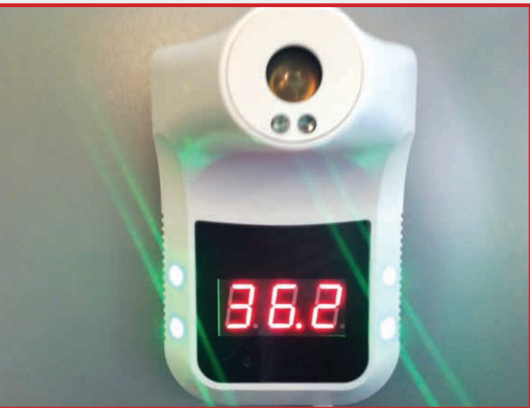
Termometro digitale all'infrarosso da parete per l'automisurazione della temperatura senza contatto fisico. Se integrato nel sistema elettronico di controllo accessi, inibisce l'ingresso quando il valore rilevato supera i 37,5 °C (courtesy: Elex)
