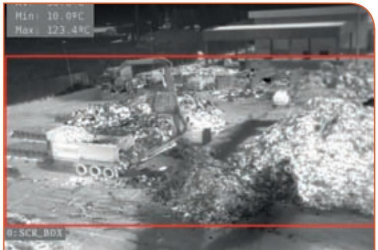
■ **Telecamere radiometriche monitorano la temperatura dei materiali da -10°C a 110°C senza necessità di contatto. Telecamere HD riprendono e inviano i dati al sistema di controllo centrale**
